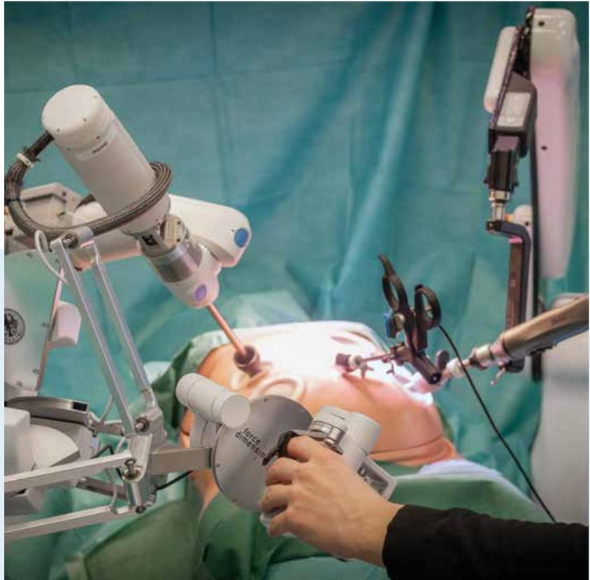
Abbildung 1: Roboterassistierte Laparoskopie an einem Phantom.
