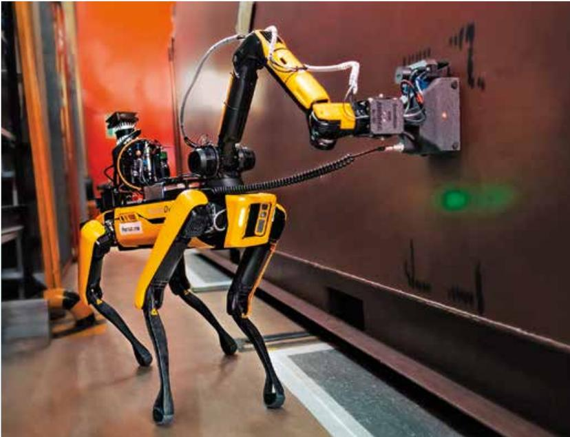
Abbildung 2: Roboter können unterschiedlich aussehen und verschiedenste Tätigkeiten erfüllen, so auch das Messen radioaktiver Strahlungen.
