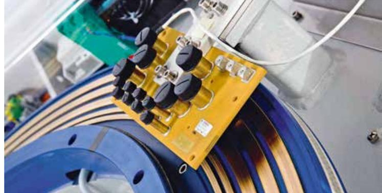
Abbildung links: Illustration eines modernen Röntgen-Computertomographen für medizinische Anwendungen; Abbildung rechts: Der Schleifring ist eine elektromechanische Baugruppe. Der durch ihn gebildete Schleifkontakt ermöglicht die elektrische Energie- oder Signalübertragung zwischen gegeneinander rotierenden Bauteilen.
