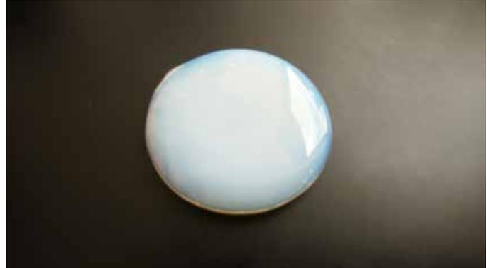
Abbildung links: Opalglas ist ein milchig-weißes, lichtdurchlässiges Glas, das für verschiedene Produkte wie Kosmetika oder Geschirr verwendet wird. Die Trübung entsteht durch Zugabe von Fluorid. Abbildung rechts: Fluorfreies geschmolzenes und ohne Wärmenachbehandlung im Labor hergestelltes Opalglas.
