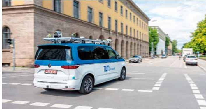
Abbildung: Forschungsfahrzeug für autonomes Fahren auf Level 5 der TU München.
