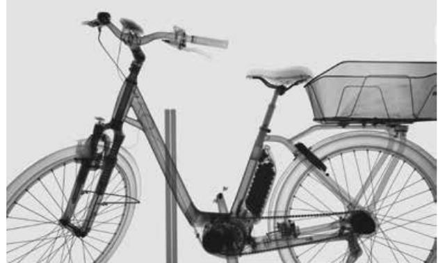
Abbildung links: Roboter-CT-System beim Scan eines Fahrrads am Technologie Campus Plattling der Technischen Hochschule Deggendorf; Abbildung rechts: 2D-Röntgenprojektion eines Fahrrads, gescannt mit Hilfe des Roboter-CT-Systems.
