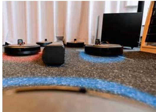
Abbildung links: Open-Source-Referenzplattform; sie besteht aus mobilen Robotern, die mit zusätzlichen Sensoren ausgestattet sind. An dieser Plattform werden die entwickelten Konzepte und Methoden der prädiktiven Wartung getestet und demonstriert; Abbildung rechts: Gleiches Setup aus der Sicht einer auf dem Roboter montierten Kamera.
